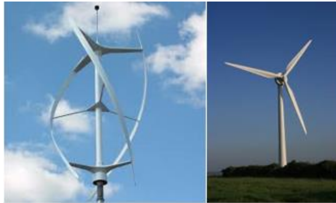
Figur 2, vindturbiner med vertikal och horisontell axel (Eastwick, 2009) (Earthmail, 2018)
